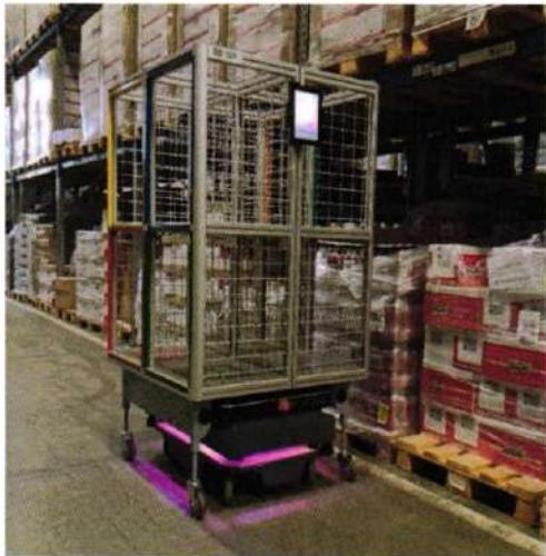
V letu 2020 smo v logistične procese vpeljali prvo avtonomno AGV (Automated Guided Vehicle) robotsko vozilo za potrebe komisioniranja oz. priprave blaga na podlagi naročil kupcev, ki ne potrebuje induktivnih zank, s pomočjo senzorjev in umetne inteligence pa se samostojno postavlja v prostoru. Vpeljava robota prispeva k prihrankom časa pri internih skladiščnih transportnih poteh pri komisioniraju manjših naročil.
