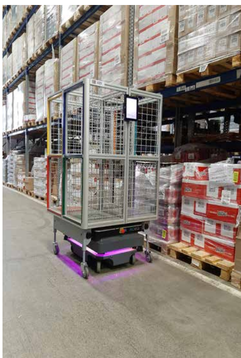
▲ Implementacija prvega avtonomnega AGV robotskega vozila
